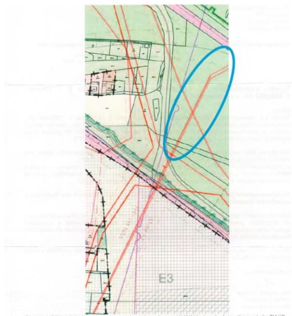
Obrázek 1: Příklad chybného zobrazení osy nadzemního vedení zvn V443/444 v koordinačním výkresu návrhu ZM ÚP
